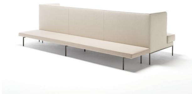
Divano con schienale e braccioli in multistrati di pioppo. Telaio sedile in tubolare d'acciaio sezione 30x50mm, verniciato con polveri epossidiche e cinghiato con molleggio a nastri elastici. Imbottitura della struttura in poliuretano espanso a densità differenziata rivestita con falde di fibre acriliche rivestita con una foderina realizzata con polietere 100 % accoppiato con supporto di vellutino poliammidico termofissato.
